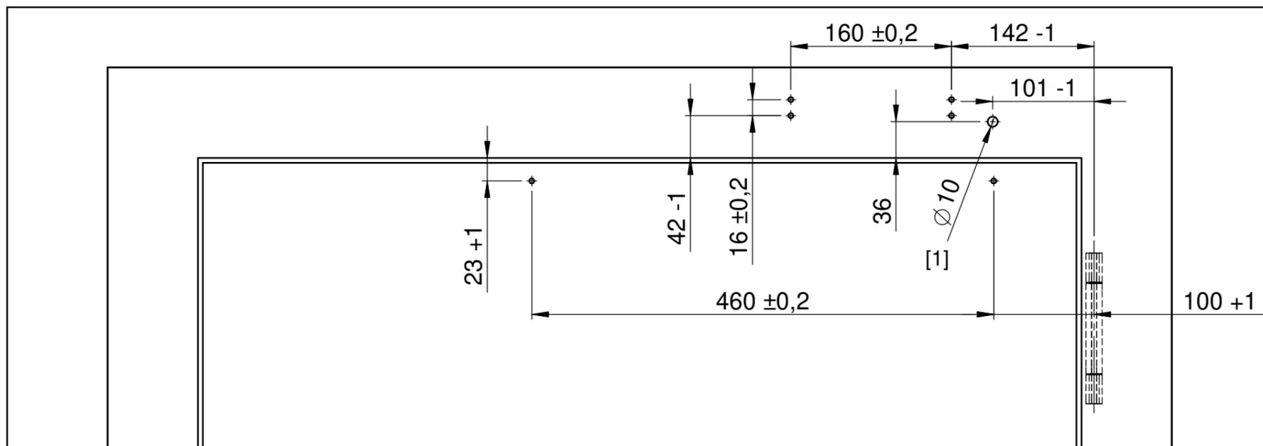
[1] Empfohlene Position für Stromversorgung bei interner Verkabelung,
