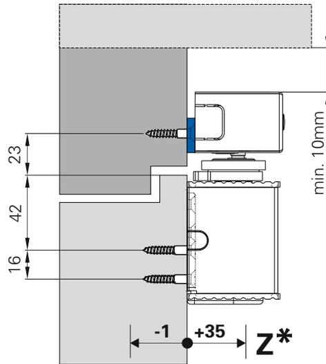
Montage mit Standardprofil Bandseite
