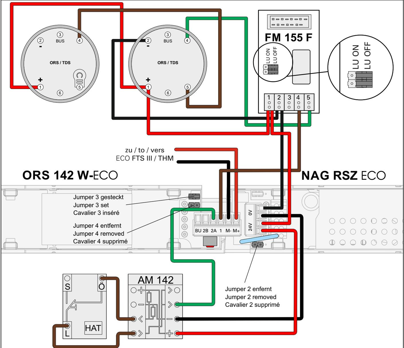
**Vor einer Umverkabelung/-konfiguration ist das Netzteil von der Versorgungsspannung trennen. Umkonfigurationen im eingeschalteten Zustand können Fehlfunktionen verursachen!**
