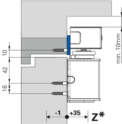
Montage mit Adaptionprofil (ADP 30) Bandseite
