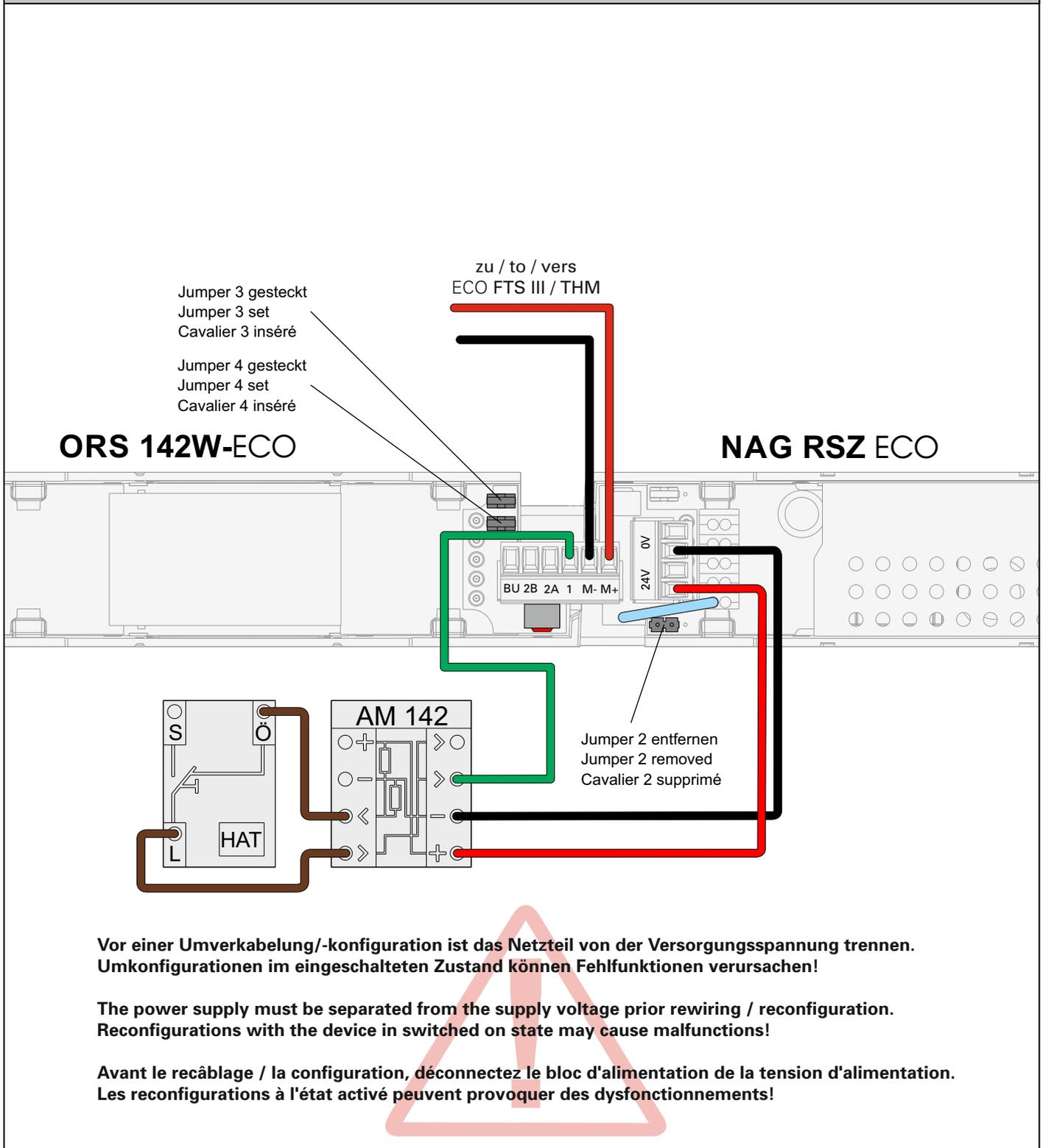
**Vor einer Umverkabelung/-konfiguration ist das Netzteil von der Versorgungsspannung trennen. Umkonfigurationen im eingeschalteten Zustand können Fehlfunktionen verursachen!**
